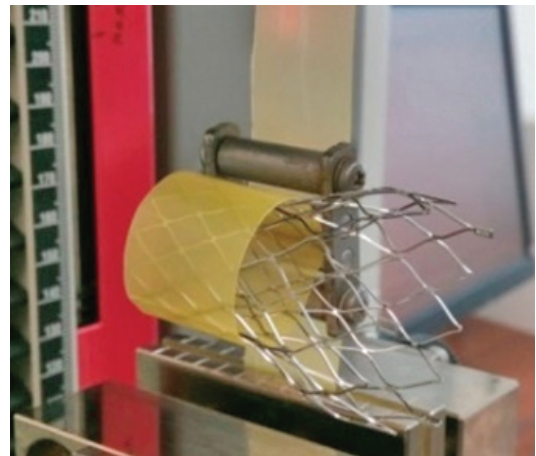
Рис. 4. Результаты исследования жесткости опорного каркаса: F – сила на трассе, Δx – изменение диаметра от исходного
