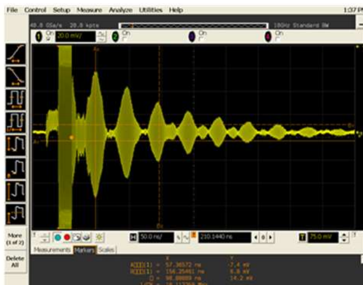
Рис.2. Осциллограмма отраженных эхоимпульсов ОСВ
