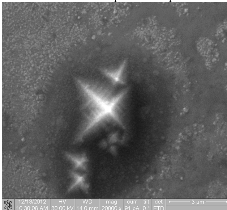
Рис. 1. Экспериментально полученный дендритный кристалл (поверхность нержавеющей стали). Исследование с помощью электронной микроскопии.
