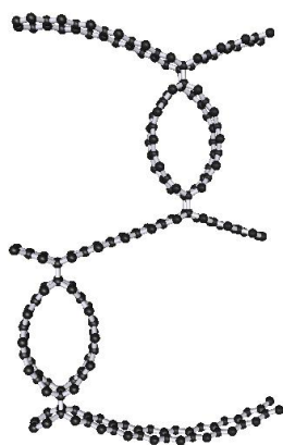
Рис. 1. Элементарная ячейка бислойного композита УНТ/графен с нанотрубками (10,0) и расстоянием между ними 10 гексагон.
