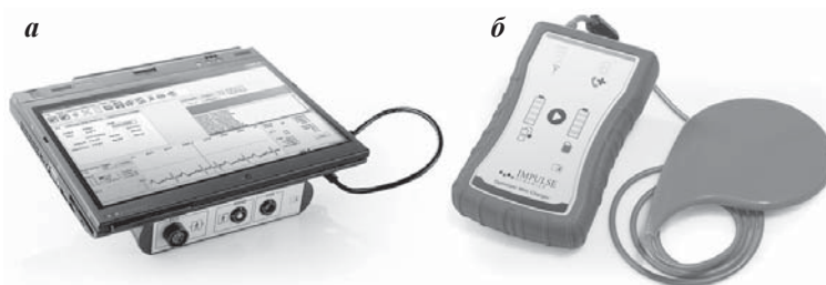
Рис. 4. Программатор (а) и зарядное устройство (б) для МСС устройств. Пациент самостоятельно прикладывает телеметрическую пластину к области имплантированного устройства. Зарядка происходит автоматически в течение 30-40 мин.
