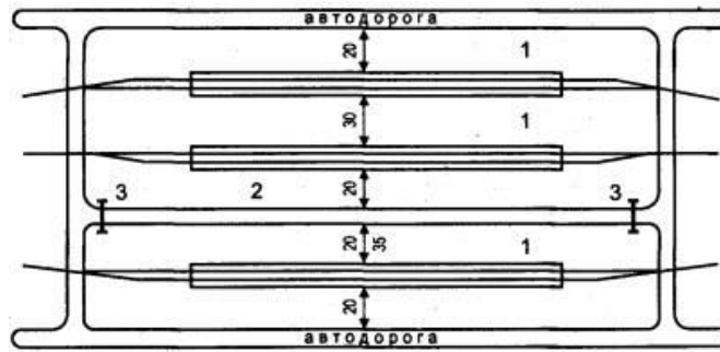
Рис.1 Схема размещения пожарных проездов при параллельном расположении нескольких сливноналивных эстакад для легковоспламеняющихся жидкостей:
