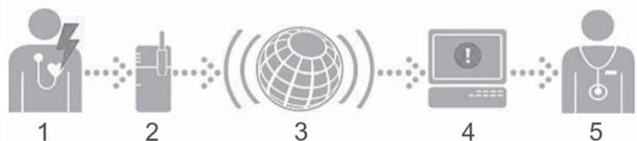
Рис. 2. Система мобильного телемониторинга электронных имплантатов для лечения нарушений ритма сердца и предупреждения внезапной смерти (BIOTRONIK Home Monitoring): 1 - пациент с имплантатом; 2 - мобильный передатчик, телеметрически связанный с имплантатом и передающий данные в сети мобильной связи (3); 4 - сервисный центр, обрабатывающий полученные с имплантата данные и передающий кардио-отчет на интернет-страницу врача (5) [43].
