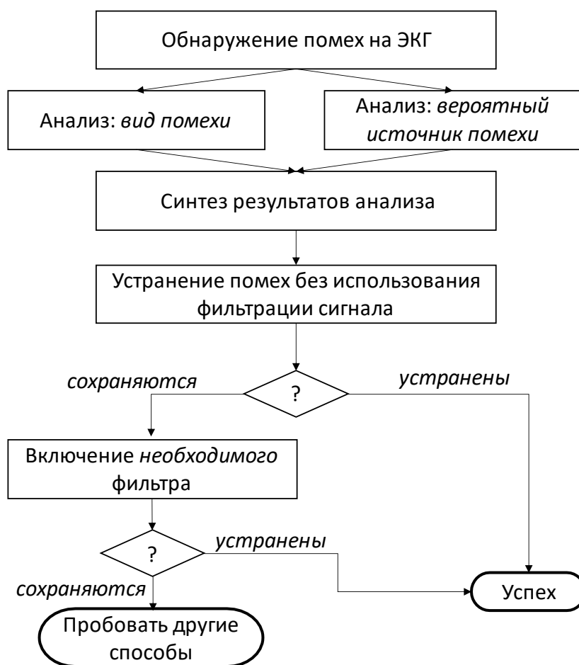
697 Рисунок 11. Схема анализа вида и вероятного источника помех на ЭКГ.
